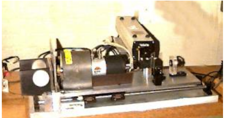
Ilustración 6. Sistema de espectroscopio Mössbauer
