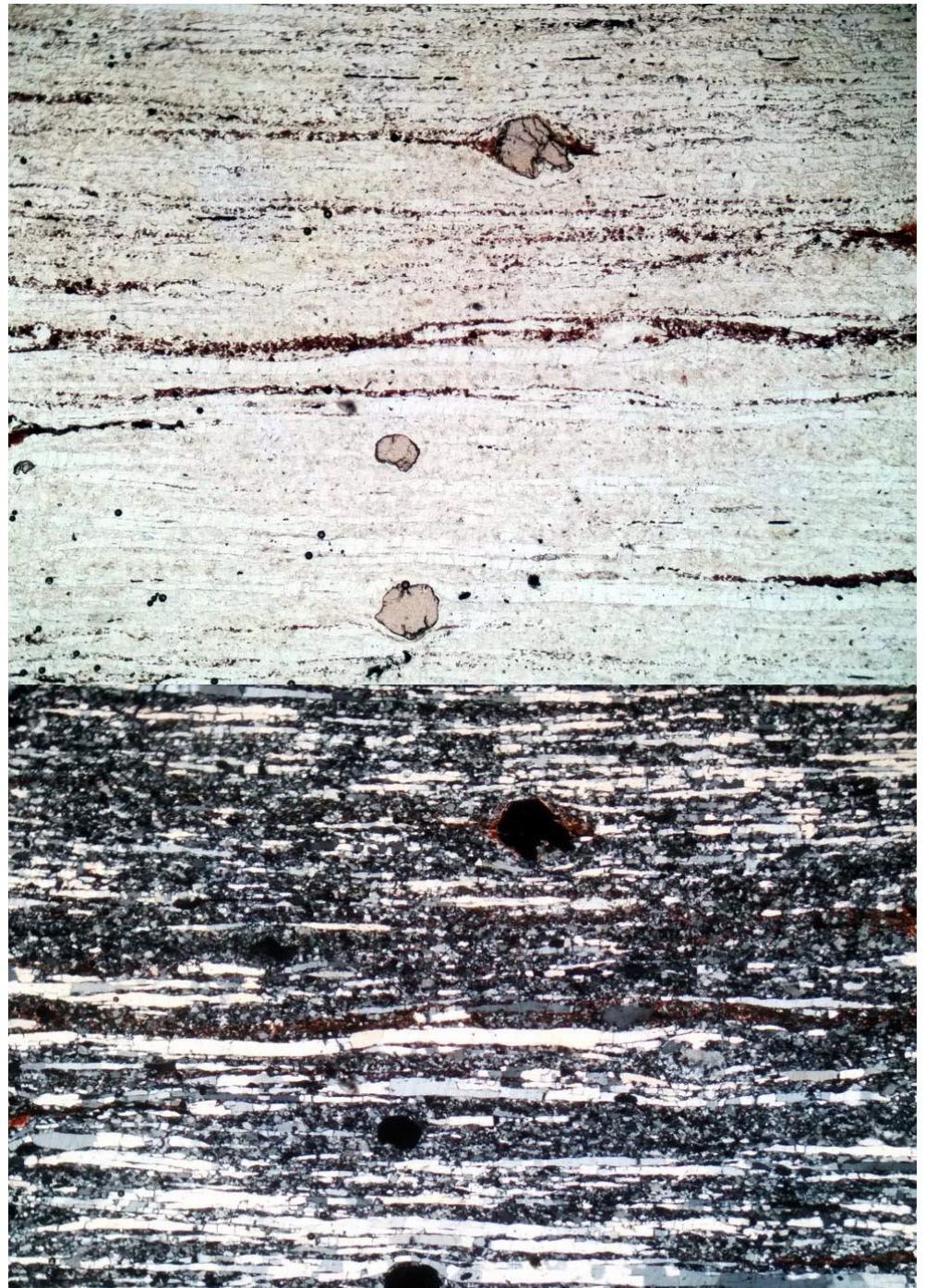
Ilustración 1. Imagen general de la roca accidentada. Matriz cuarzofeldespática, cuarzo acintado, biotita de grano fino y porfiroclastos de granate. Arriba, nícoles paralelos (//); abajo nícoles cruzados (X). Campo de visión (CDV) de 5 mm.
